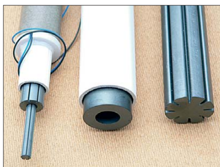
Bild 30: Stabkernauführungen; gefiederter Hohlzylinderkern mit eingeschobenem gefiederten Stabkern (links), Hohlzylinderkern mit 30 mm Durchmesser (Mitte), gefiederter Stabkern mit 30 mm Durchmesser (rechts)
