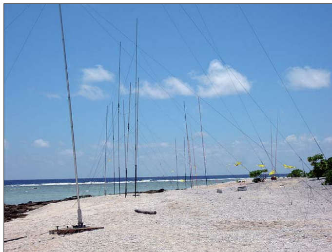
Eine der beiden Antennenfarmen von NH8S; die unmittelbar am Salzwasser aufgestellten Vertikalantennen gewährleisteten die erwünschte Flachstrahlung.
