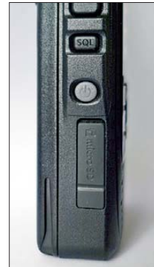
Die Einschalttaste ist nun auf die linke Seite gewandert. Unter der Abdeckung befindet sich der Steckplatz für eine Micro-SD-Speicherkarte.
