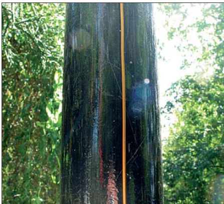
Bild 1: Strahler aus Kupferlackdraht, entlang eines 18-m-GFK-Masts geführt Foto: DK5WL
