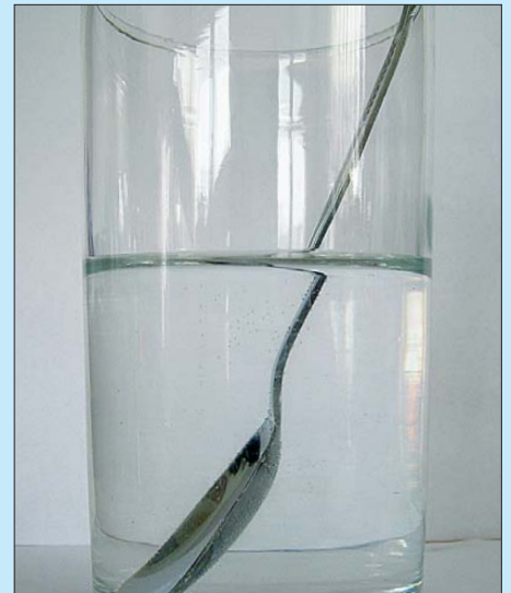
Bild 10: Brechung beim Medienübergang Foto: DD6AE
