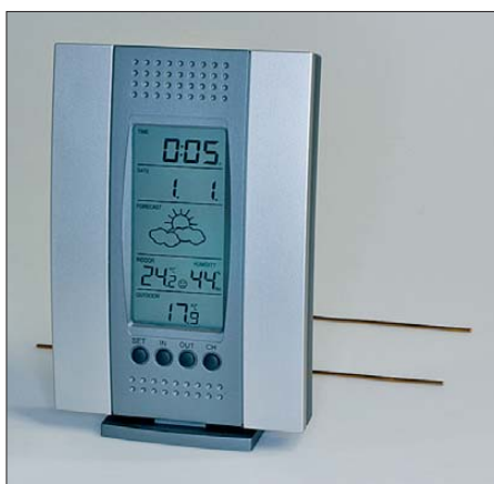
Die Wetterstation Focus von Dostmann arbeitet auf 868 MHz. Als Empfangsantenne ist eine kleine Schleife im Inneren des Gehäuses untergebracht. Doch auch bei ihr können zwei hinter das Gerät gelegte zusätzliche Antennenelemente zu einem verbesserten Empfang führen. Gegebenenfalls sind die in diesem Fall 173 mm langen Drähte senkrecht anzuordnen. Foto: Red. FA
