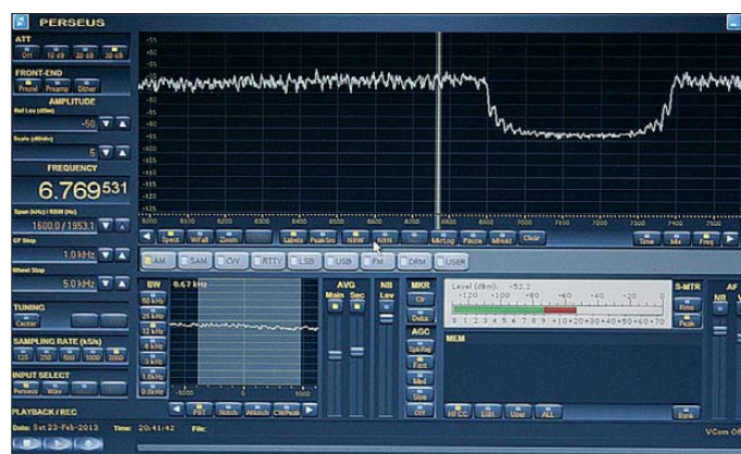
Bild 2: Der PLC-Störpegel und dessen Absenkung im 40-m-Amateurband
