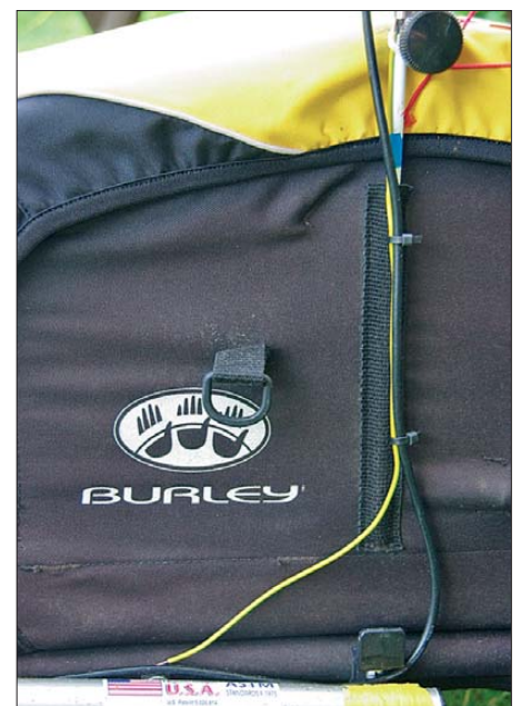
Ein Segment des Metallsteckmastes der in der Fahnenstangenhalterung befestigten Antenne ist mit Kupferdraht mit dem Aluminiumrahmen des Fahrradanhängers verbunden.
