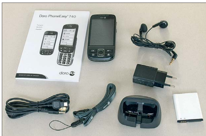
Bild 2: Lieferumfang des Doro PhoneEasy 740: Handbuch, Gerät, Ohrhörer, Stecker- netzteil, USB-Kabel, Halteschleife, Lade- schale, Akkumulator
