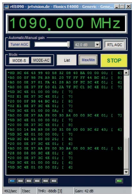
Bild 4: Die Software rtl1090 bietet Funktionen zur Einstellungen des Empfängers und zeigt laufend die Anzahl der pro Sekunde empfangenen Frames an.
