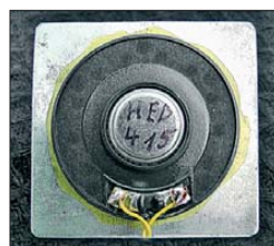
Bild 9: Die als Sensor dienende Kopfhörerkapsel ist plan auf das vorbereitete Weißblech zu kleben. Fotos: Siebert
