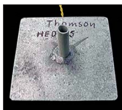
Bild 8: Auf das 50 mm x 50 mm große Weißblech ist in der Mitte ein kleines Loch anzubringen und ein dünner Stützen zu löten.
