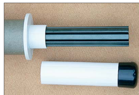
Bild 31: Verlängerung der Induktionsspule durch zusätzliche Rohrstücke; die Gesamtlänge des Rohres beträgt 86 cm. Angereiht sind vier Stabkerne mit je 30 mm Durchmesser und 200 mm Länge. Die Spule hat 100 000 Windungen (CuL, 0,18 mm).
