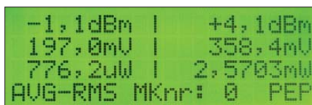
Bild 22: Signalpegel meines Zweitongenerators; dieser hat einen IMA3 von etwa 90 dB.
